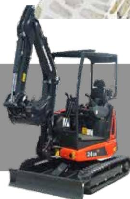
Entrambi i modelli possono essere dotati di roll-bar di protezione a quattro montanti o cabina. La scelta permette una versatilità senza uguali: ingombro minimo per prestazioni al massimo.
