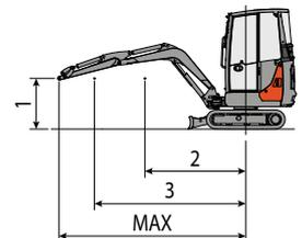
La capacità di sollevamento è basata sulla norma ISO 10567 e non eccede oltre il 75% del carico statico di ribaltamento o dell'87% della capacità di sollevamento idraulico della macchina.
